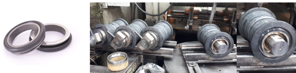
Figura 3,4 e 5 – Respectivamente: juntas de vedação; rolete; detalhe para o retentor na montagem.
